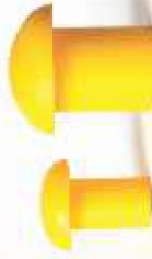
کپ بار یک محافظ پلاستیکی برای انتهای میلگرد هاست. این قطعه می تواند از آسیب دیدگی کارگران در کارگاه های عمرانی جلوگیری کند. رنگ مناسب، موجب می شود به پهلوانی شکل قابل رویت باشد. این قطعه برای میلگرد های با قطر ۸ تا ۲۲ مماسب است.
