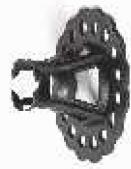
پلیبار یک فاصله نگهدار با کف پهن (سطح مقفعه زیاد) است. دارای دو کاور متفاوت است که در تقاطع میگردها اسناده از آن را بسیار راحت می کند. پلیبار برای سطوح نرم و فرو رونده و همچنین برای دیوارهای عایق و قابله های بیرونی مناسب می باشد. پلیبار برای پوشش بتنی ۲۰ و ۴۰ میلیمتر و برای میلگرد با قطر ۸ تا ۱۴ میلیمتر می باشد.
