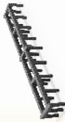
ایزیچیر یک فاصله نگهدار از ان و محکم با قابلیت نصب آسان است که برای اسناده در زیر میگردد های کف و سقف کاربرد دارد. این محصول در سیسیستم قالب تونلی نیز استفاده می شود. ایزیچیر برای پوشش بتنی بین ۲۰ تا ۳۰ میلیمتر و برای میلگرد با قطعه های مختلف اسناده می شود. طول این اسپیسر بین ۲۰ تا ۲۵ میلیمتر می باشد.
